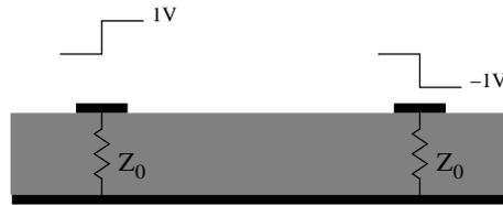
Abbildung 2.13: Schnitt durch zwei differenziell angesteuerte Übertragungskanäle mit kontrollierter Impedanz
