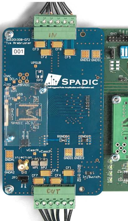
Abbildung 1.1: Prototyp des SPADIC-Chips und der zugehörigen Platine in einer Version vom Oktober 2010 (Foto: [4])
